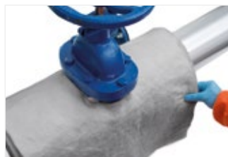
Figure 57: Enveloppez les brides pour enfermer la vanne et entourez d'un fil de fer pour le maintien en place.
