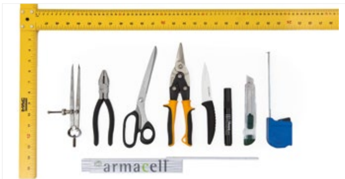
Figure 5 : Outils recommandés pour application d'ArmaGel HT.
