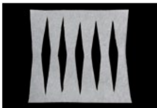
Figure 38: Formez des découpes en forme de diamant à partir des poissons inverses dans la feuille ArmaGel HT.
