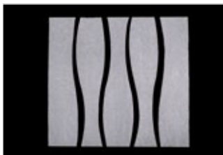
Figure 34: Coupez les poissons afin qu'ils correspondent exactement à la circonférence du tuyau. N'oubliez pas de prévoir un demi élément de départ / finition.
